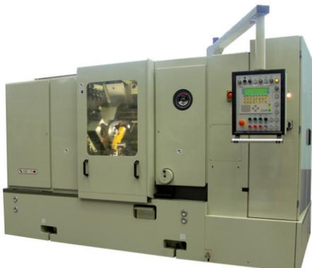
Bearbeitungsdurchmesser: bis 32 mm
