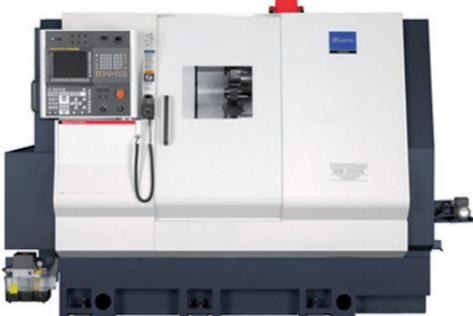
Bearbeitungsdurchmesser: bis 51 mm
