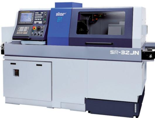
Bearbeitungsdurchmesser: bis 32 mm
