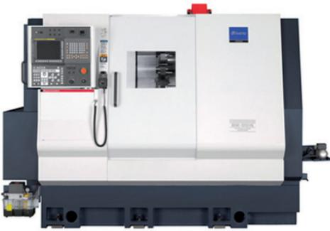
Bearbeitungsdurchmesser: bis 51 mm
